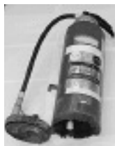
▲破裂事故をおこした消火器
