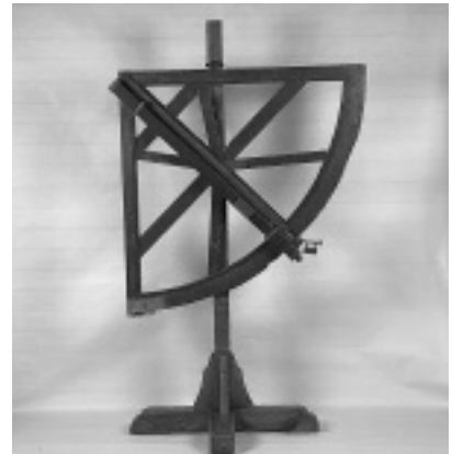
測量に持参した組み立て式の中象限儀。重さ約90kg、運搬には分解しても馬2頭が必要であったといわれている。
