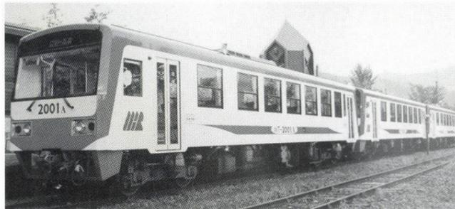
▲平成13年度に延命工事（大規模な補修工事）が施されたMT2000型式のレールバス3両。基金からの補填により、合わせて1830万円の費用を投入しました。これにより10年程度の延命が期待できます。
